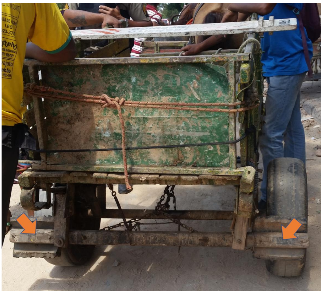
“Freio-tora” com sapatas de borracha (setas laranja).
