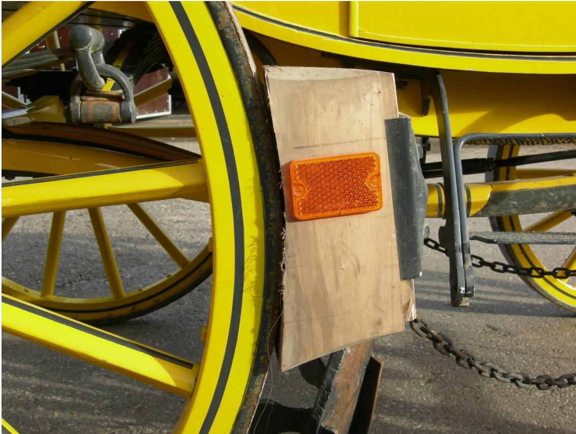
Freio de sapata feito de pedaço de tora de madeira, sobre roda de carruagem.
